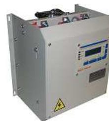
Ограничение максимального пускового тока электродвигателя с помощью ДМС обеспечивает уменьшение ударных пусковых нагрузок на механизмы и снижение пиковых нагрузок на питающую сеть.
